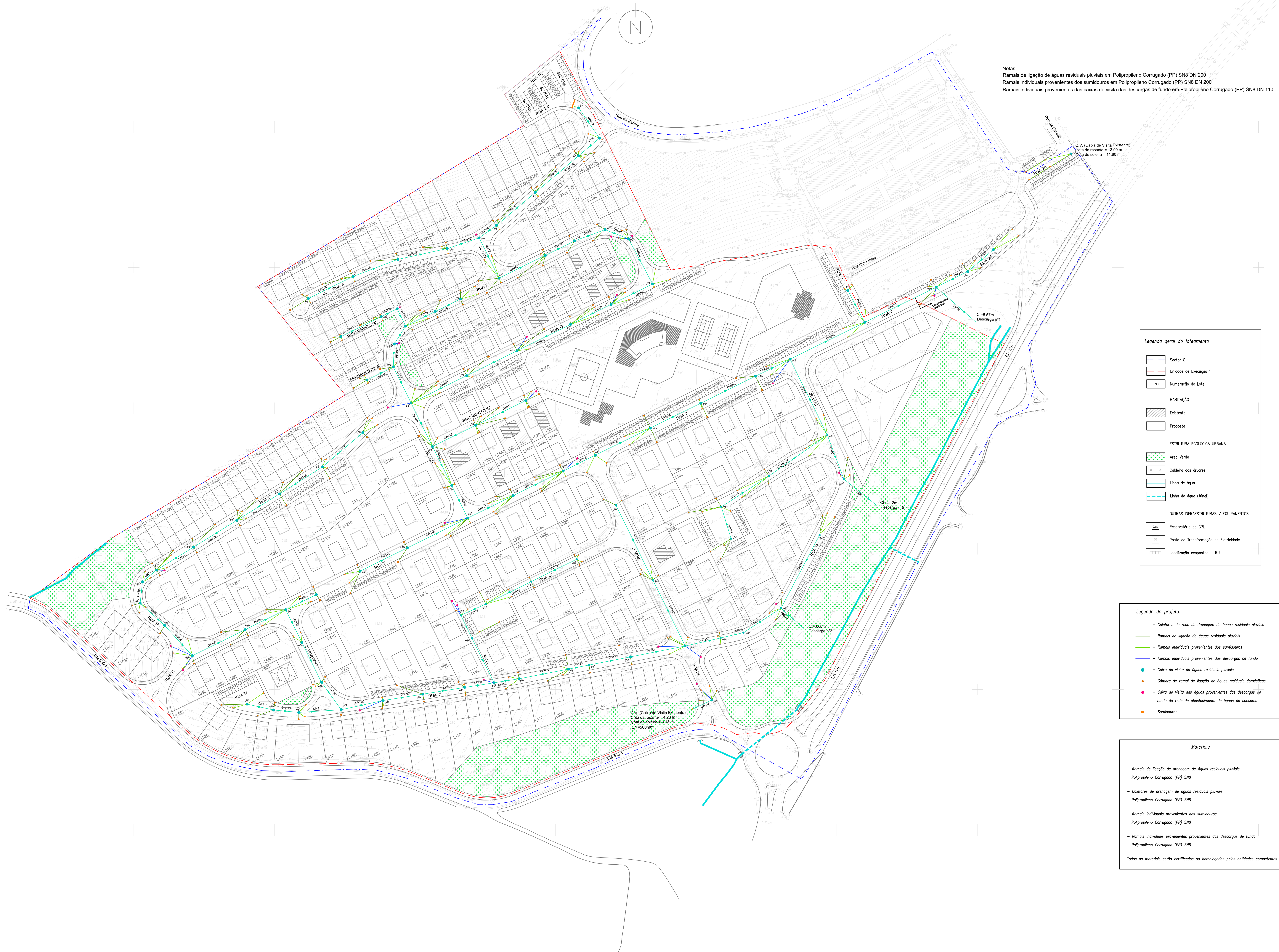
Planta geral da rede de drenagem de águas residuais pluviais sobre planta topográfica Escala 1:1000
